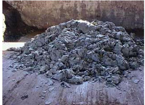
を町外に出さずに、すべて町内に閉じこめる有機物循環のクローズシステム構築を目指して、下水道汚泥を町営牧場の家畜堆肥と混ぜてコンポスト化しています。この背景には、最終処分場の確保の困難と廃棄物減量化の必要性、ダイオキシン発生抑制のため焼却の廃止、化学肥料に依存した農業生産体系の見直し、食物の安全志向と有機農産物の需要増大～が挙げられています。
